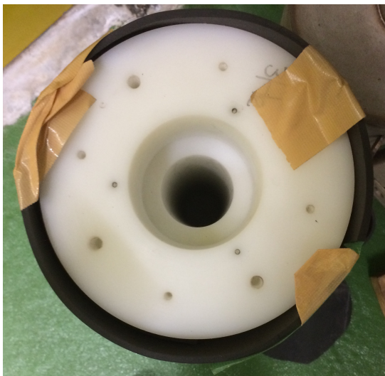
図 3.2: 減速材 (ポリエチレンカバー、ボロンシート)
