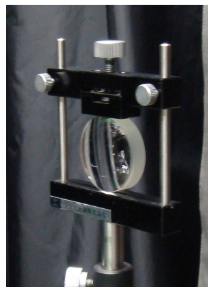
図 4.10: 実験に用いたアクロマティックレンズ
