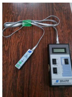
図 4.10 ガウスマーター (ホール素子により 3 軸の磁場を測定できる)
