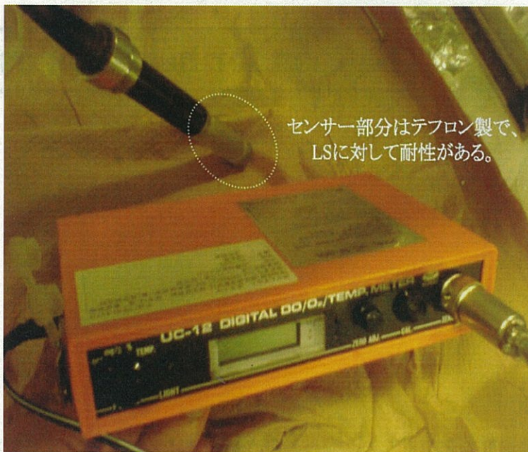
図 5.7: 溶存酸素濃度計：センサー部分がテフロン製で液体シンチレーターに対して耐性がある。
