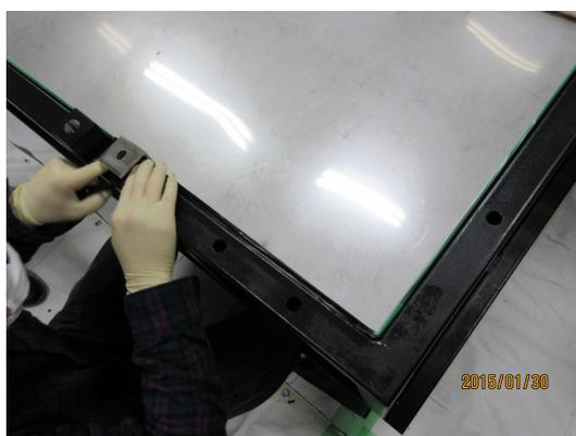
図 6.52: 光漏れのあった隙間をブラックテープで塞ぐ様子
