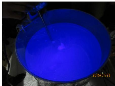
図 6.44: 液体シンチレータに紫外線ランプをあてた様子
