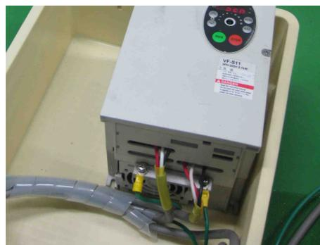
図 6.33: ターゲット層用液体シンチレータ用ポンプ 図 6.34: ポンプ電源周波数制御用インバータ
