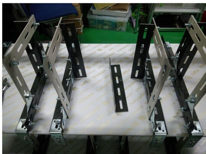
図 6.38: 側面 PMT 固定具の写真
