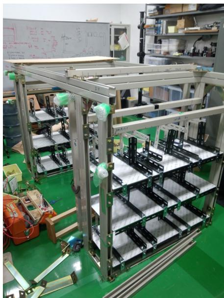
図 6.37: PMT 設置用棚の写真
