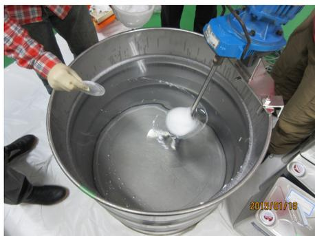
図 6.43: 液体シンチレータの攪拌の様子
