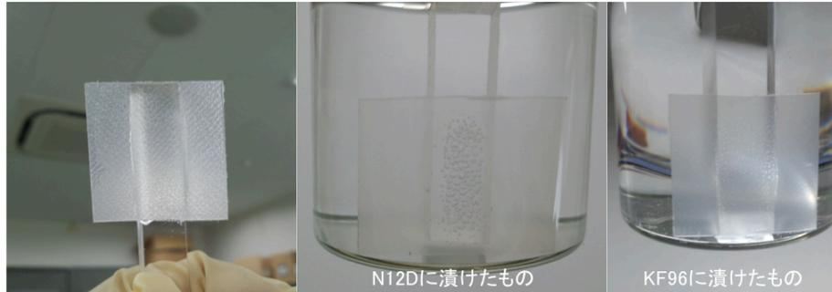
図 6.27: 接着剤のテストの写真 (左から付ける前、ミネラルオイルに浸けたもの、シリコンオイルに浸けたもの)
