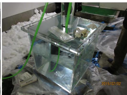
図 6.56: 内側アクリル容器の水張試験の様子
