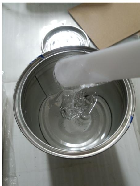
図 6.30: KF-96 100 万の粘度の様子
