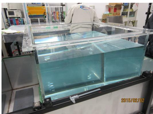
図 6.55: 外側アクリル容器の水張試験の様子
