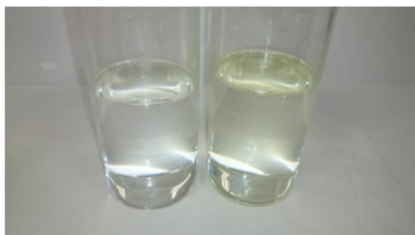
図 3.65: 新しい液体シンチレータの黄ばむ様子 (左:製作直後、右:製作から1週間後)
