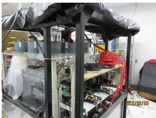
図 6.59: PMT を設置し配線を行う様子
