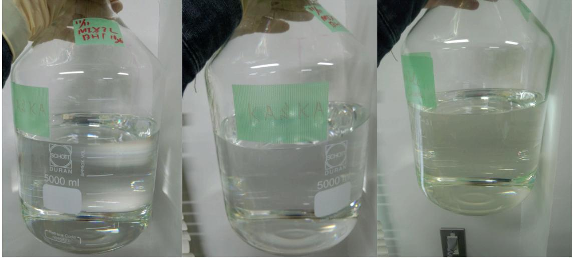
図 3.67: 大きいバイアルでの新しい液体シンチレータの経年変化の様子 (左から製作直後、2週間後、1か月後)
