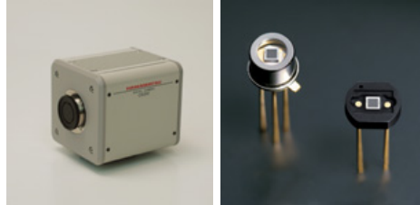
図 3.13: イメージインテンシファイアと MPPC
