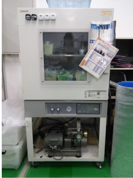
図 3.25: 加速劣化試験に用いる対象物用の恒温槽
