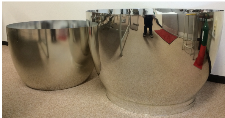
図 3.2: 試作した集光ミラー（左図：17インチPMT用、右図：20インチPMT用） [34]
