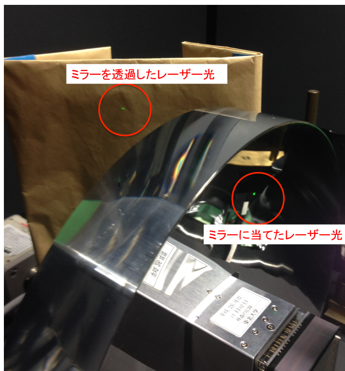
図 6.11: レーザーポインタの透過光
