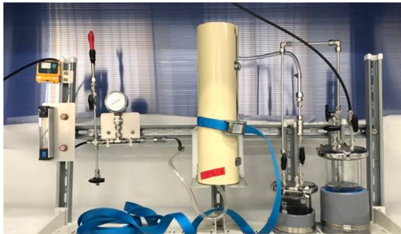
図 5.2 バブリング装置の写真。左から伸びる黒いチューブが窒素供給ライン、近くに黄色い酸素濃度計が取り付けられている。中央のクリーム色の筒の中に \text{ThO}_2 線源が入っている。その左に 2 つあるガラス容器のうち左側が LS で、右側がバッファーであり、上部に伸びる黒いチューブは排気口に繋がる。
