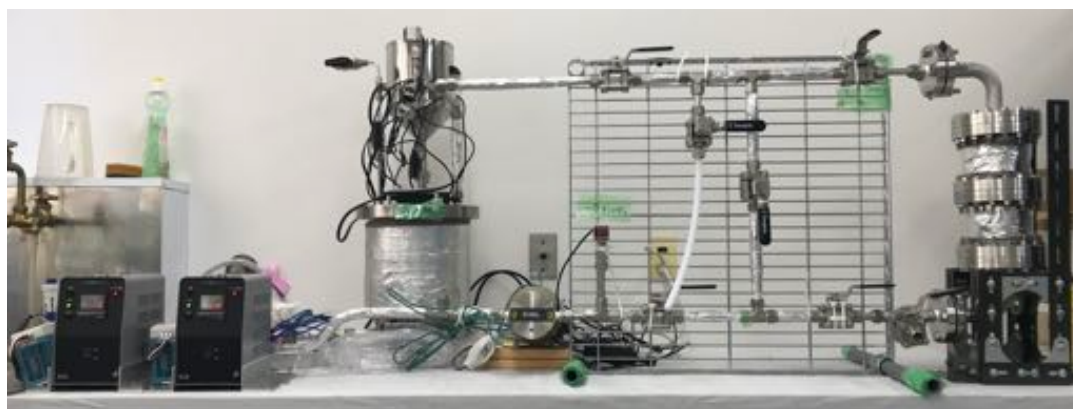
図 4.10 KamLAND への実装を想定した純化装置。装置の右端にある構造物が実機カラムである。断熱のため、ガラスウールなどで全体を覆っている。
