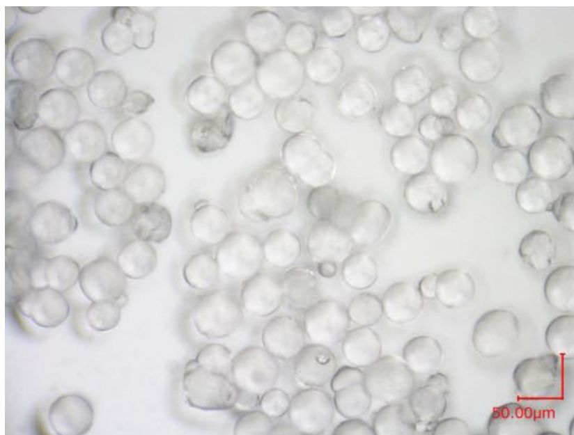
図 B.1 デジタル顕微鏡で観察したメタルスカベンジャーの粒子。R-Cat-Sil AP を撮影したものである。ほとんどが丸い形状であることが分かるが、中にはいびつな形や 2 粒子が繋がったような形のものも見られる。
