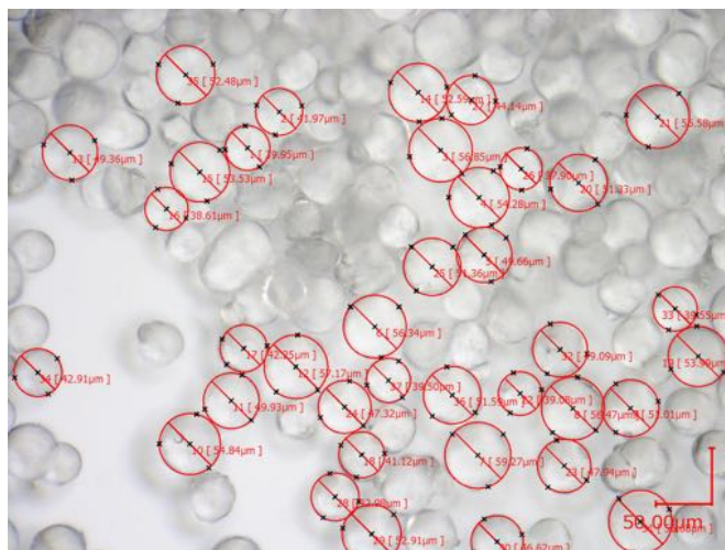
図 B.2 メタルスカベンジャーの粒子径測定
