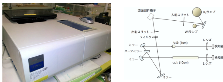
図 4.1: 分光光度計と測定原理
