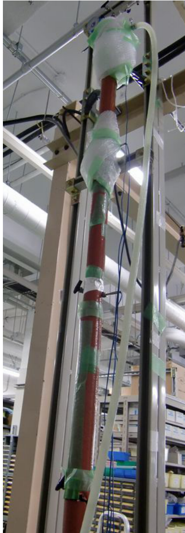
図 4.2: Xe 溶解度分布測定装置
