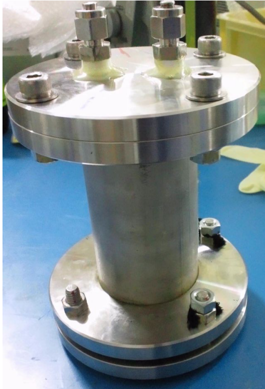
図 5.1: 加圧試験容器外観
