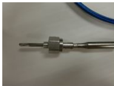
図 4.6: 熱電対 (温度ポート内部)
