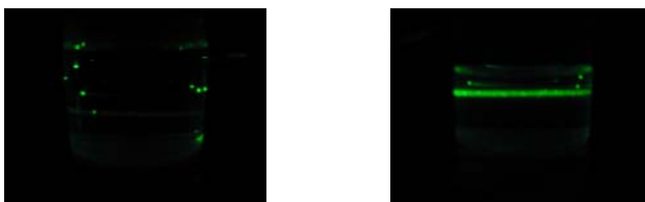
(a) 透過率の落ちていない NaI 水溶液 (b) 加速試験後の透過率の落ちた NaI 水溶液
