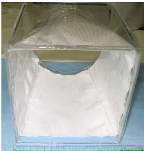
(b) ライトガイドの反射シートの構造
