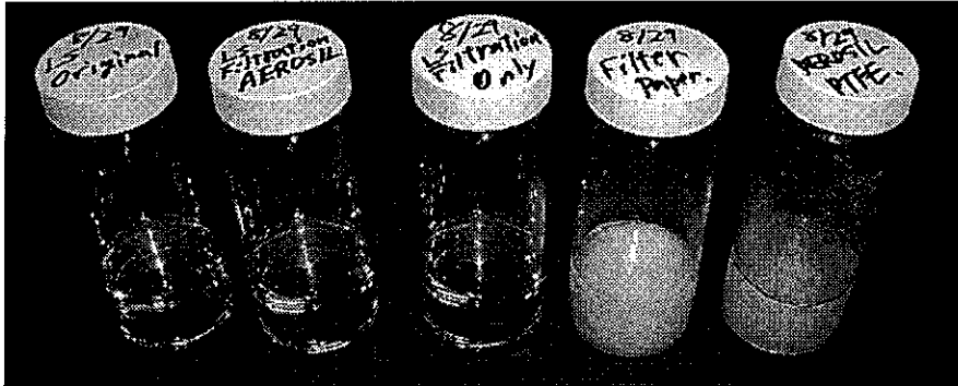
図 3.2: 1 回の実験で作った試料の例。左から、1. バブリング後何も化学操作をしなかった試料、2. 濾過後に \text{SiO}_2 粉末に吸着させた試料、3. 濾過のみ行った試料、4. 濾過に使った濾紙を 0.1mol/l 硝酸中で粉碎した試料、5. 吸着後の \text{SiO}_2 粉末
