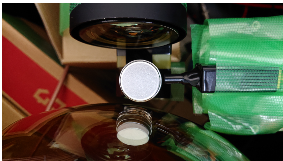
図 4.3 LED のセットアップ (俯瞰図)。LED の光を直接 PMT に入射させないようにコリメートしている。
