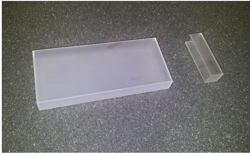
図 4.4: サンプル用 100mm セル (左) とリファレンス用 10mm セル (右)
