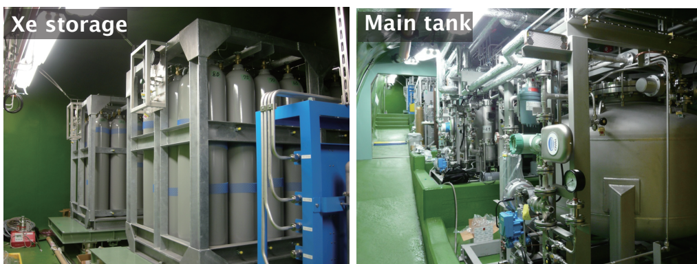
図 2.16: キセノンガス貯蔵ボトル (左) と Main tank(右)
