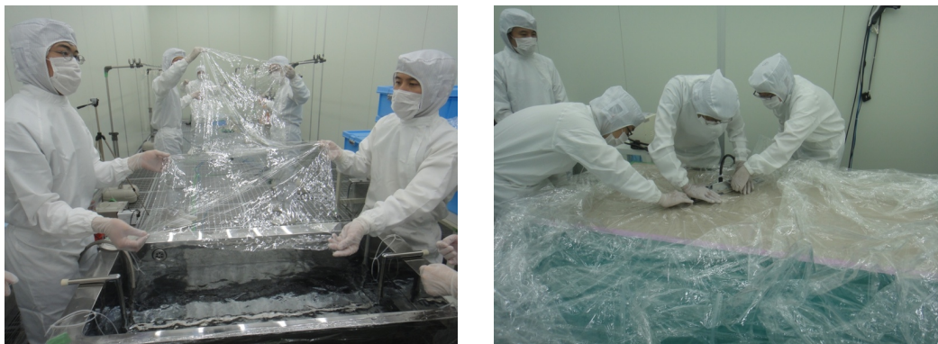
図 2.9: スーパークリーンルームでの Inner-Balloon 製作の様子 (左) ナイロンフィルムの超音波洗浄 (右) フィルムの溶着
