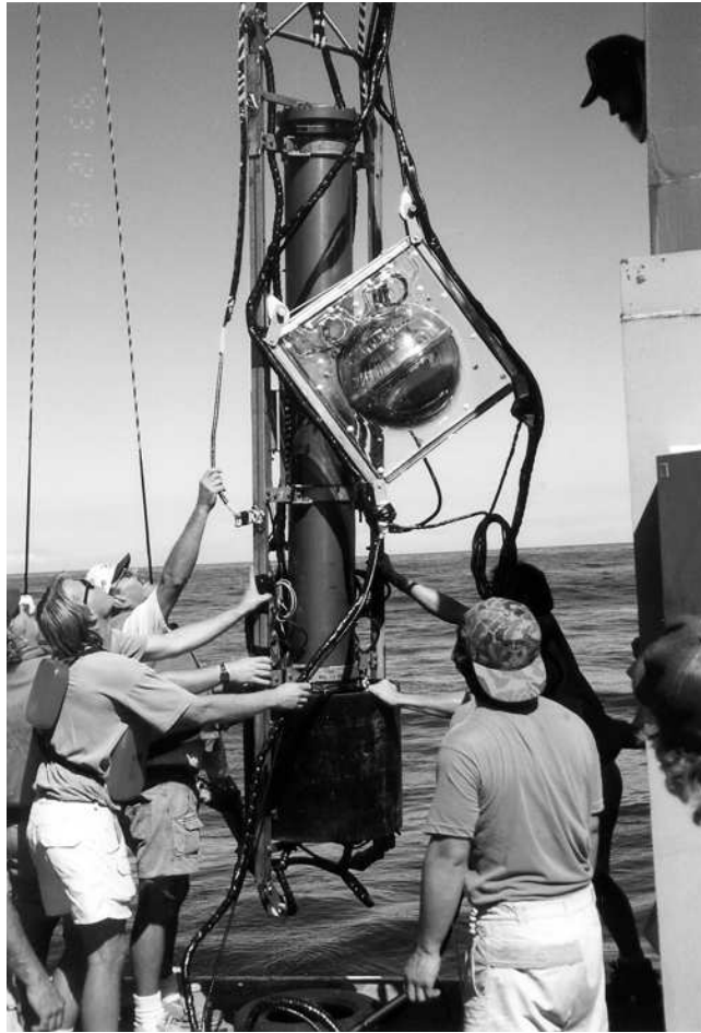
図 6.2: 検出器設置現場の写真：正面に見えるのがストリング制御装置と光検出器である。
