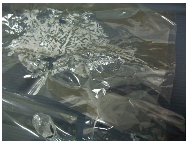
図 7.8: レゾルシノールによるフィルム溶着テスト
