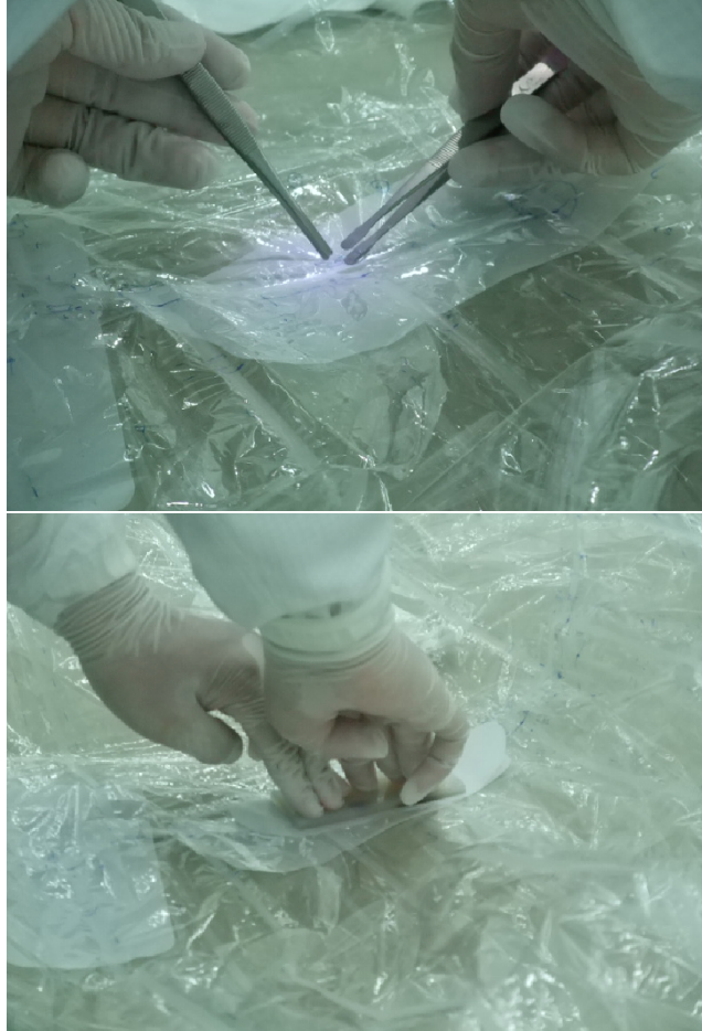
図 7.11: 補修作業の様子：上がアロンアルファをリーク箇所に塗布する作業。直接アロンアルファを流し込むと量の調整が出来ないため、ピンセットに僅かにアロンアルファを付けて、それを流し込んでいる。下はナイロンフィルムのパッチを貼付けた後に押し付けている様子。
