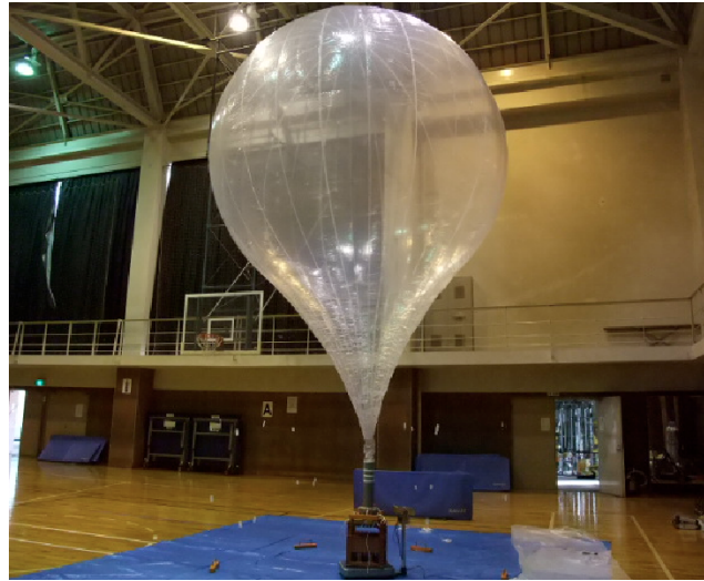
図 8.3: 東北大体育館でのヘリウム+ N_2 ガスによる膨らませテスト
