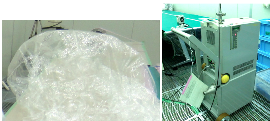
図 7.5: ヘリウムで膨らんだ mini-balloon とヘリウムリークディテクター
