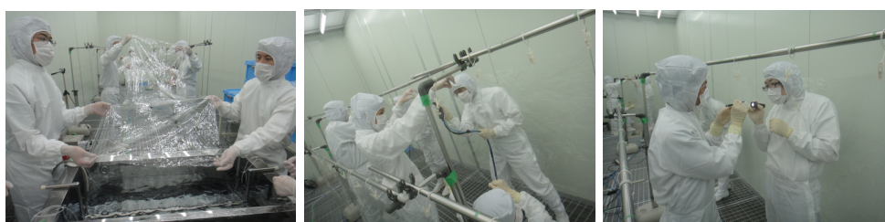
図 7.2: 左から順に超音波洗浄、窒素による乾燥、キズやピンホールのチェック
