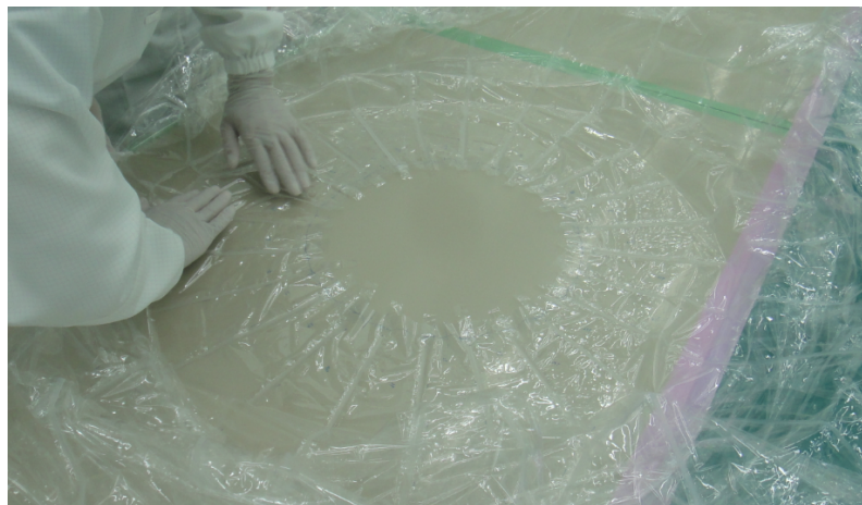
図 7.7: バルーンの内極部：24本のゴアが南極部に集中するため、非常に複雑な構造をしており、溶着線が集中しているのが分かる。
