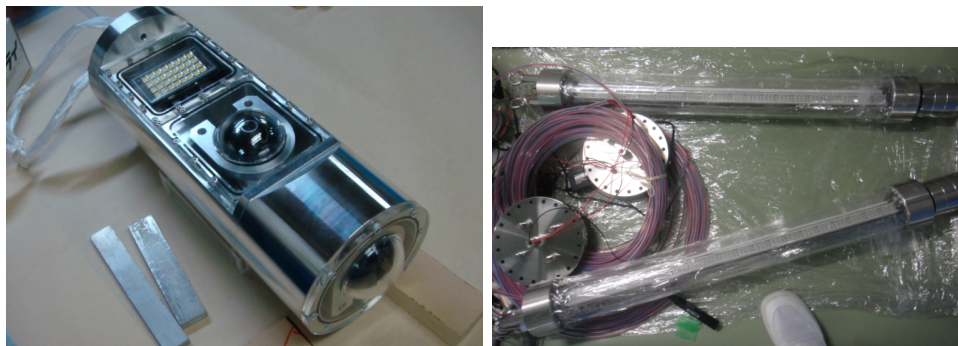
図 8.6: Web カメラを 2 台使用し、側面と底面を確認出来る監視装置 (左) と、アクリルで封じられた LED ライト (右)
