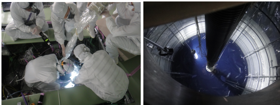
図 8.8: KamLAND 開口部への mini-balloon 投入と開口部から見た KamLAND 内部
