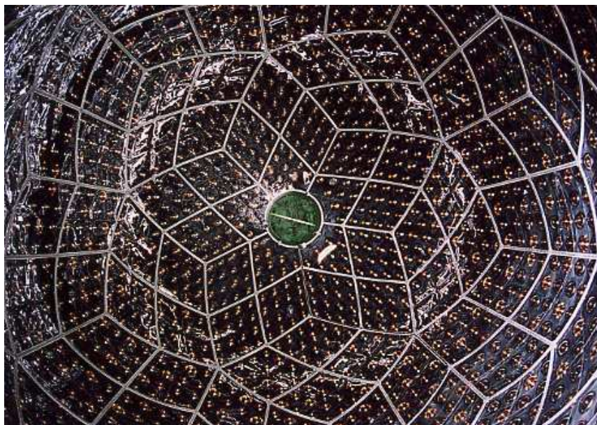
図 1.20: 検出器内部の光電子増倍管の配置
