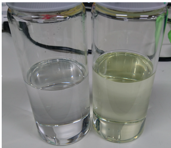
図 4.7: ナフタレンによる黄ばみ
