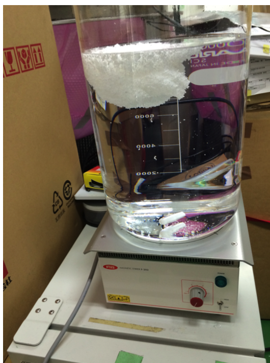
図 5.25: 高濃度 Gd 液シンの作製
