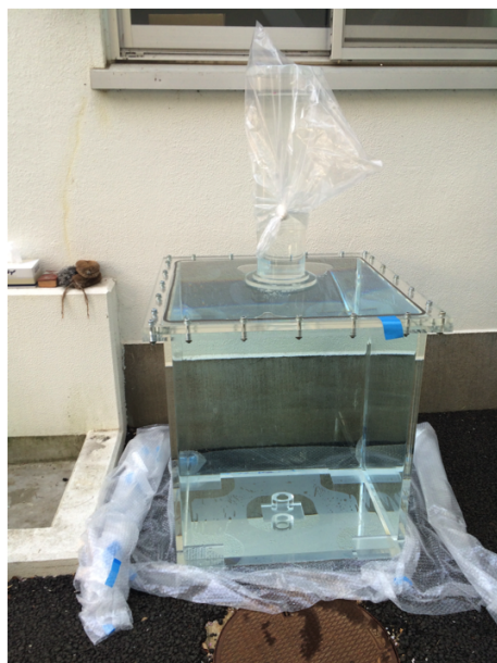
図 5.1: 内層の水張り試験
