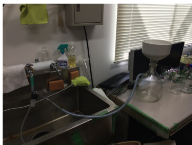
図 4.20: アスピレータを使ったろ過の様子
