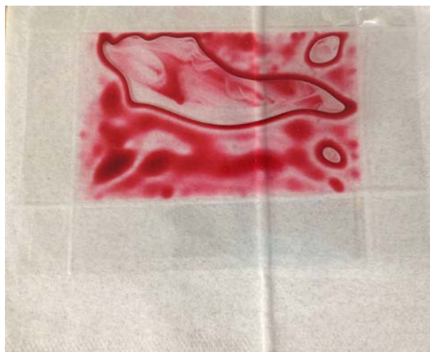
図 4.41 インパルス溶着部のリークチェック
