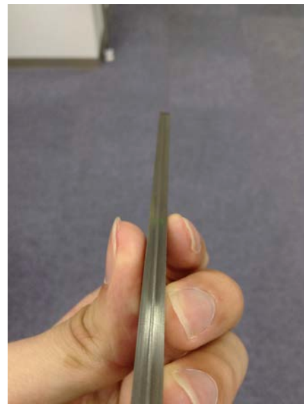
図 I.3 受けジグ。真ん中の細い線に当たる部分が溶着線となる。
