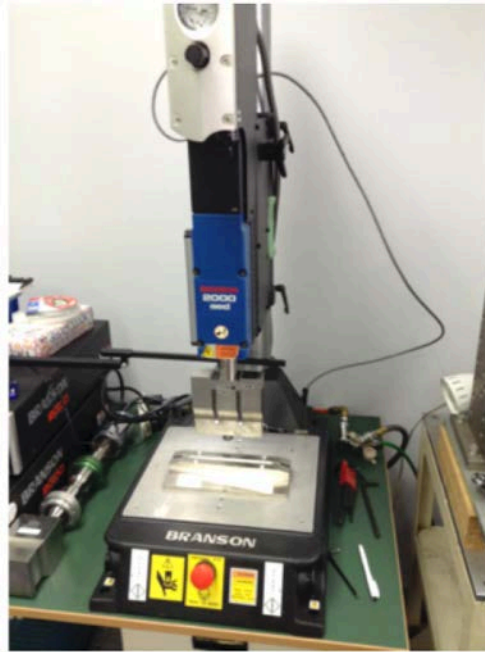
図 I.1 20 kHz 超音波溶着機 (BRANSON)。図はプレス溶着用のホーンを装着している。
