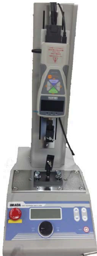
図4.38 デジタルフォースゲージ「ZTA-500」と計測スタンド「MX2-500」。どちらもイマダ社製。
