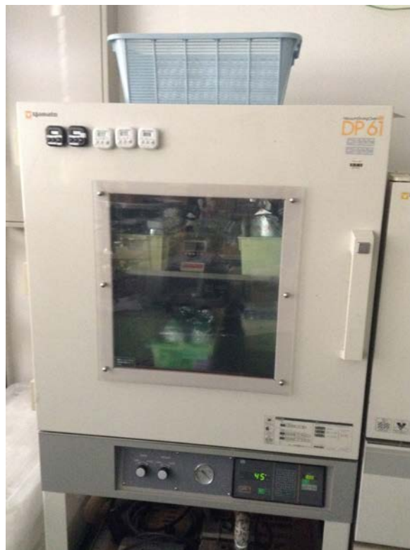
図 H.1 恒温槽
