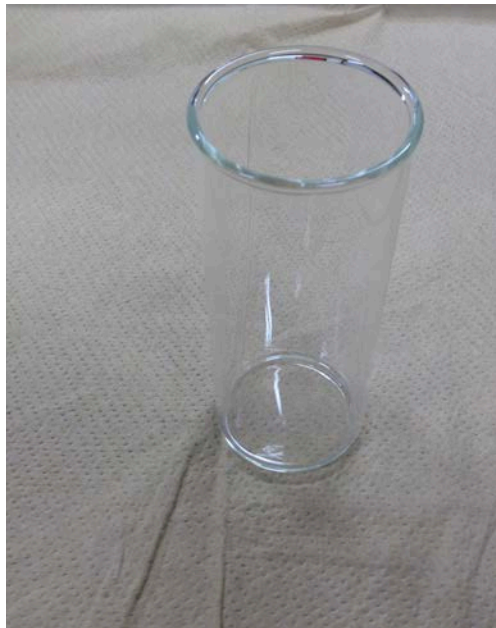
図 G.6 底面平らな特注バイアル。PMT 光電面上に置いた際に、バイアル底面の形状と光電面の形状を近くすることで空気層が少なくなる。さらにバイアル底面と光電面の間隙をミネラルオイルで埋め、屈折・散乱による影響を低減する。このバイアルを用いることでエネルギー分解能が向上する。
