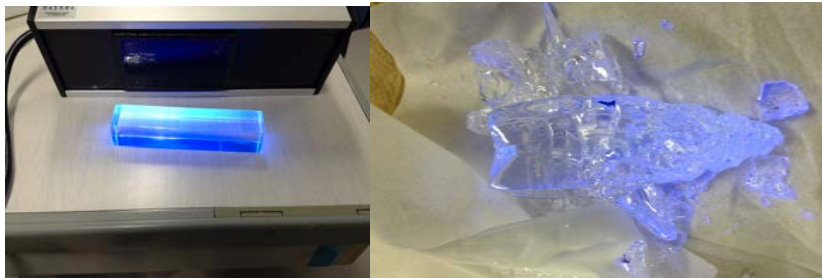
図 4.1 プラスチックシンチレータ (左図) を 30 日間 PC に浸けておいたもの (右図)。どちらもブラックライトを当てている。PC 耐性のないプラスチックシンチレータはゲル状となり、使用に耐えない。
