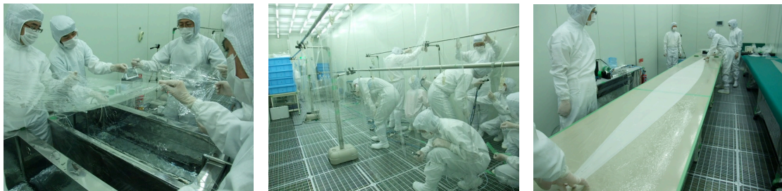
図 4.9: フィルムの洗浄、破損確認行程、ゴアの切り出し行程
