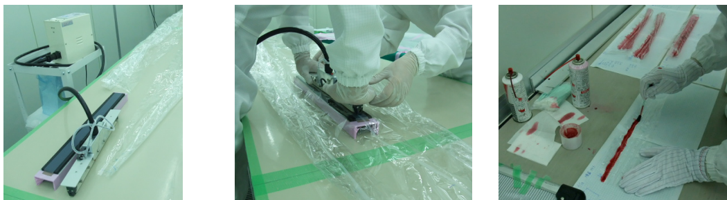
図 4.10: フィルムの溶着過程
