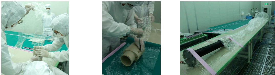
図 4.11: PEEK 材、コルゲート管の接続
