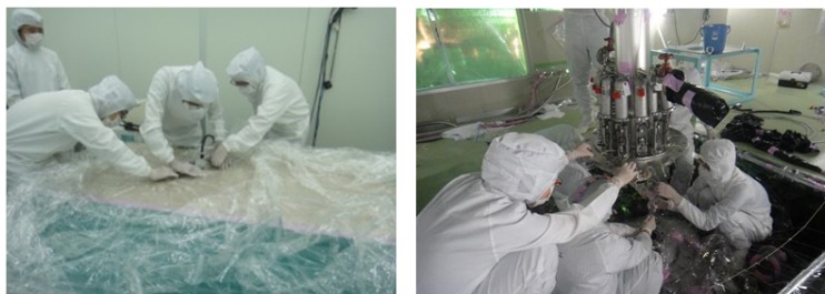
図 2.3: ミニバルーンの製作・インストールの様子
