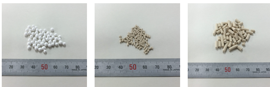
図 4.17 実験で用いた吸着剤の外観。左から順に、活性アルミナ、モレキュラーシーブ 13X 1/16、モレキュラーシーブ 13X 1/8 である。
