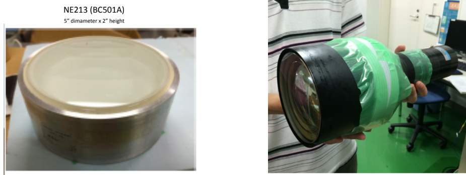
図 4.14: 左：測定に使用した NE213。容器の内側の白色の部分が反射材となっている。右：5inchPMT(R1250-03)
