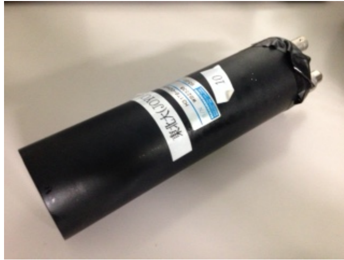
図 3.4: OV の読み出しに使用した 1.5inchPMT(H3178-02MOD) の写真
