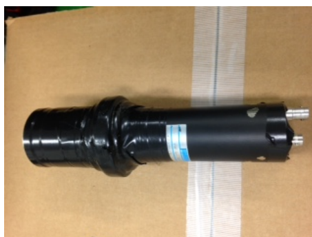
図 4.9: 測定にした NaI シンチレータと 1.5inchPMT(R3178-02MOD)
