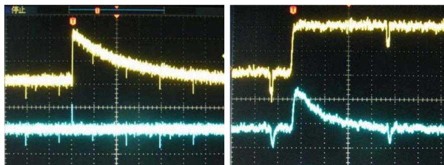
図 3.10 BLR によるオーバーシュートの回復性能 [12]。黄色の波形が入力信号で、青色の波形が出力信号である。左図のグリッドサイズは  $200 \mu\text{s}, 5 \text{ mV}$  である。右図は左図の拡大図であり、グリッドサイズは  $0.5 \mu\text{s}, 5 \text{ mV}$  である。
