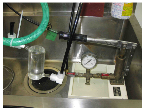
図 2.14: バイアルの圧力試験
