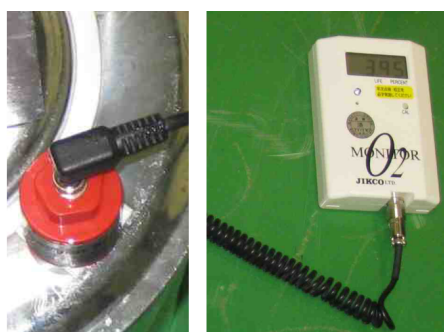
図 2.20: チムニー用気中酸素濃度計 (左図はセンサー部、右図は本体)
