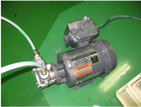
図 2.17: 液体シンチレータ循環用ポンプ 図 2.18: ポンプ電源周波数制御用インバータ
