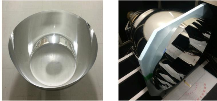
図 7.2: 集光ミラーの試作品。PET にアルミニウムが蒸着されている。[38]
