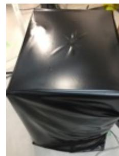
図 5.9: プラスチック段ボール 図 5.10: 内部は黒紙で覆って 図 5.11: 遮光布を 3 重にして
