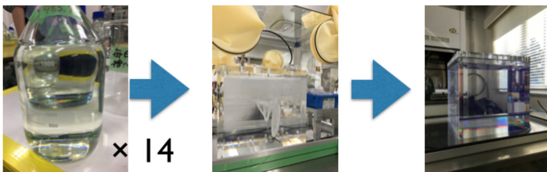
図 5.5: LiLS の作成過程:左の写真は、2L の試薬瓶に LiLS を作成した時、真ん中はアクリルボックスに LiLS を入れ窒素パージをしている時の写真、右は完成した LiLS である。
