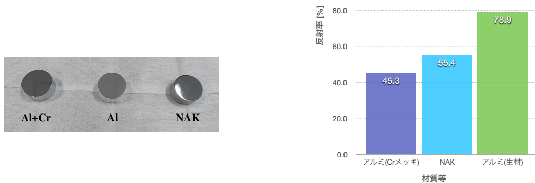
図 4.7: 左図:3種類の反射板サンプル, 右図:反射板サンプルの反射率測定の結果
