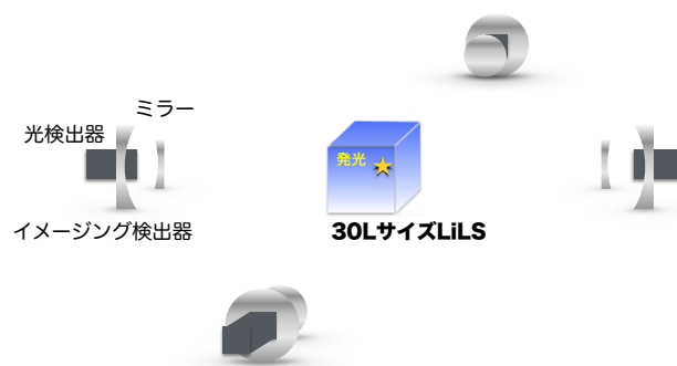
図 4.1: 30L サイズの LiLS を撮像対象としたセットアップ計画
