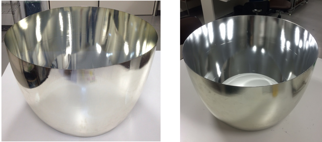
図 C.2: 銀蒸着ミラー（左図）とアルミ蒸着ミラー（右図）
