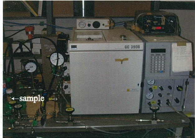
図 5.4: ガスクロマトグラフと測定するガスをガスクロマトグラフに送る系 (右の写真) と測定するガスを送る系の模式図 (左)
