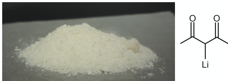
図 5.3: リチウムアセチルアセトナートの形状と構造式
