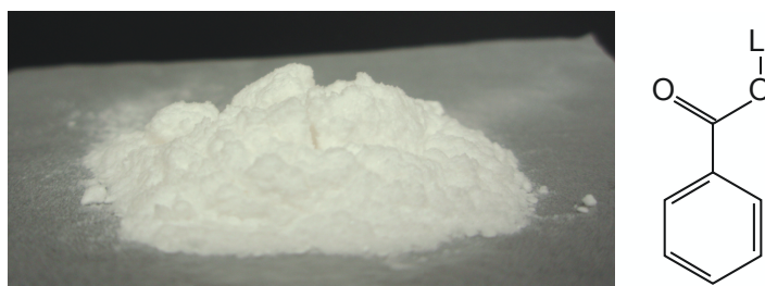
図 5.5: 安息香酸リチウムの形状と構造式
