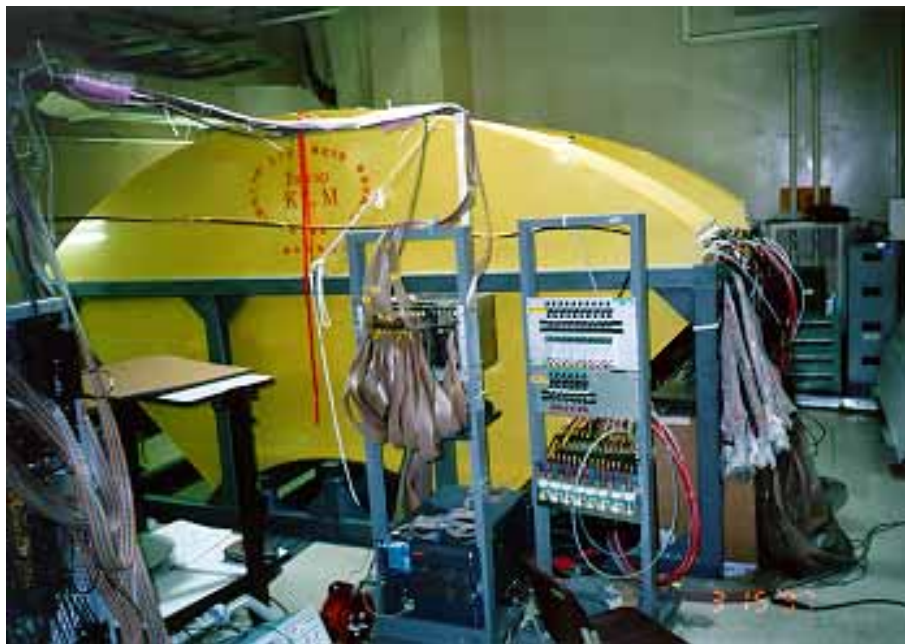
図 5.2: テストベンチの配置の図。中央の扇型のものが測定するモジュール
