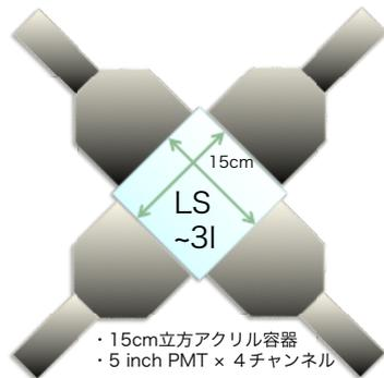
図 6.9: 実験 B) セットアップ概略図
