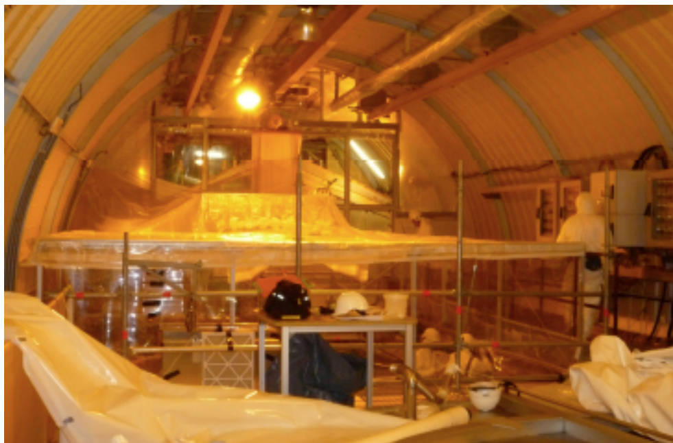
実験室全景。埃を防ぐため全体をテントで覆っています。
