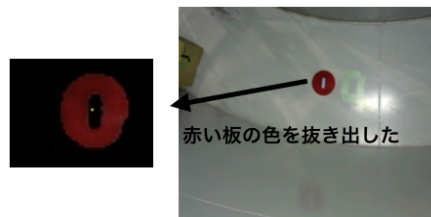
図 3.31: 液漏れ判定テストを行っていた時の画像の赤い板の色を抜き出し
