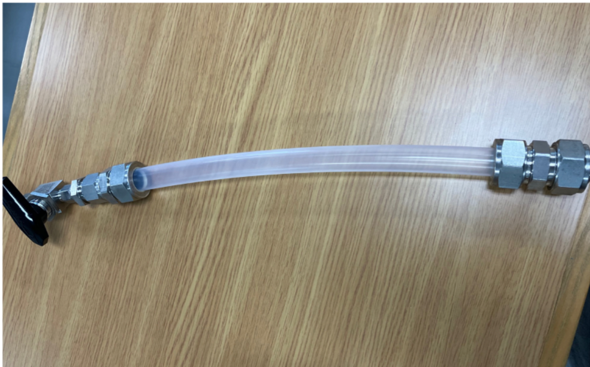
図 5.10: 圧力補償機構
