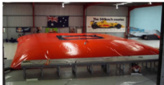
図 5.3: Hanohano で考案された Compensator bag [6]
