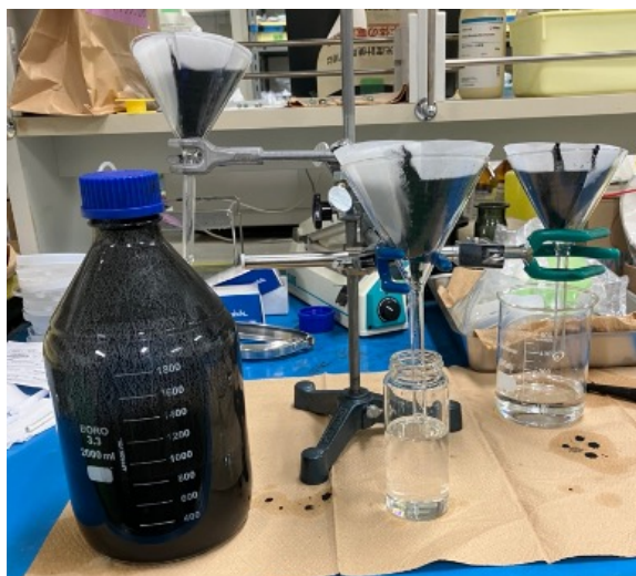
図 6.5: LAB 純化の様子
