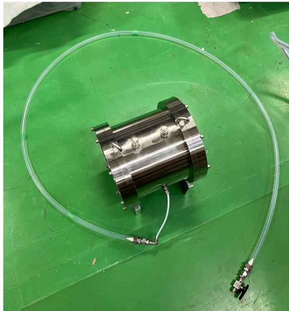
図 5.29: 圧力補償系 完成版
