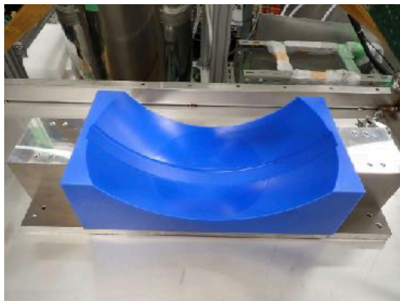
図 6.2: 光検出器モジュールの台座
