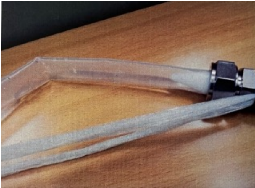
図 5.23: 耐圧試験 4 回目 結果
