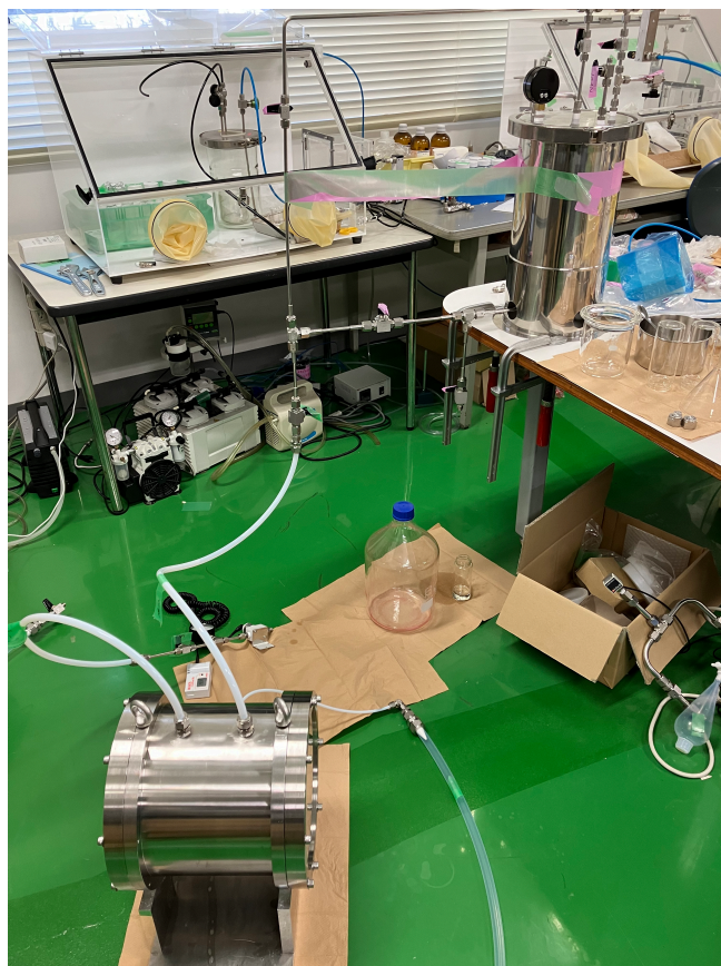
図 6.6: 窒素バブリングに用いた装置系
