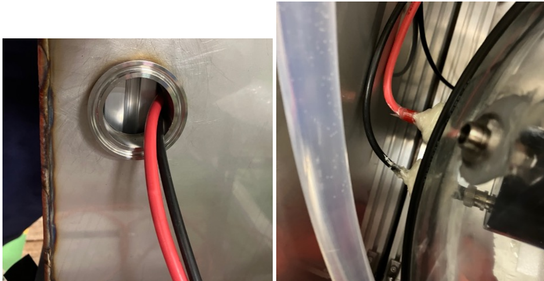
図 6.13: ケーブルが干渉している様子
