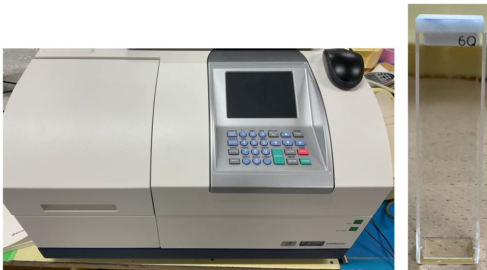
図 6.8: 蛍光スペクトル測定に用いる機器、器具。左図：蛍光高度計 F-2700、右図：石英セル (蓋付き)
