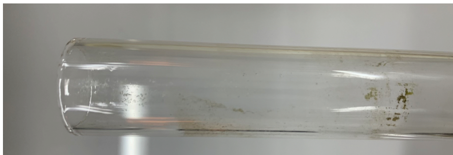
図 5.18: 一度目の石英管を洗い出した後の写真。黒く見えるのが焦げついて残っている Bis-MSB
