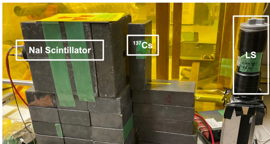
図 6.4: 発光量測定 of セットアップ。NaI 側の光電子増倍管には-1700 V、液体シンチレータ (LS) 側には-1800 V の電圧を印加している。
