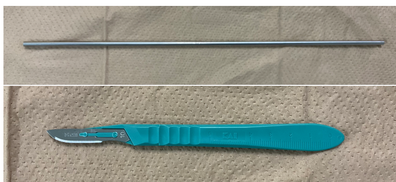
図 4.4: 試料の取り出しに用いた金属棒 (上) と試料の切り出しに用いたメス (下)
