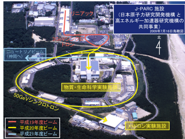
図 2.1 J-PARC の陽子ビームライン [13]。JSNS 2 は中央の物質・生命科学実験施設 (MLF) 内で行われる。リニアックで 400 MeV まで加速された陽子ビームが 3 GeV シンクロトロンでさらに加速され MLF まで届けられる。
