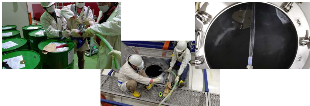
図 4.1 DIN 追加時の様子。ドラム缶に入っている DIN をアイソタンク内の GdLS へ追加している。
