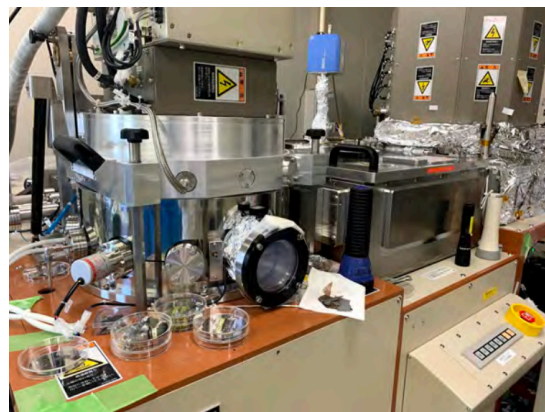
図 4.7: 理化学研究所クリーンルーム内の DC マグネトロンスパッタ装置の写真
