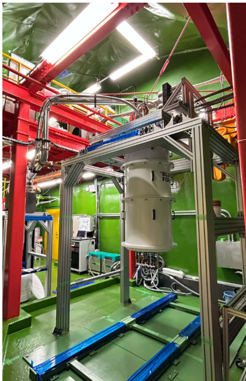
図 2.16: 神岡極稀現象研究拠点 (Kamioka Extremely Rare-phenomena and NEutrino-research Laboratory: KERNEL) に導入された希釈冷凍機 (Bluefors 社製 XLD400)
