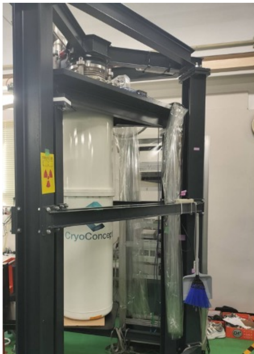
図 4.13: 測定に用いた希釈冷凍機 (Cryo Concept 社 HEXADRY UQT-B 200)
