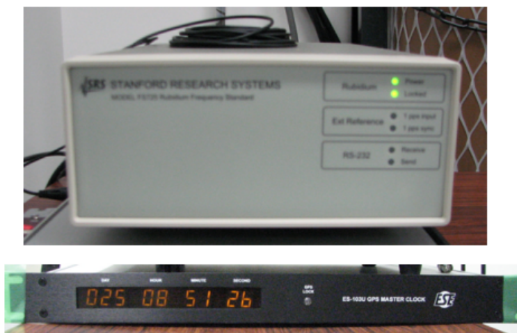
図 4.6 Rb 標準時計/GPS 受信機 [13] : 上が Rb 標準時計, 下が GPS 受信機.
