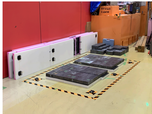
(b) テスト測定検出器下に設置した鉛ブロックシールド
