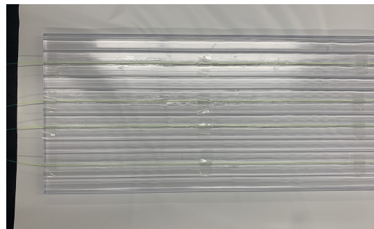
(c) 板シンチレータの全体図。シンチレータに掘られた溝にファイバーを4本埋めている。
