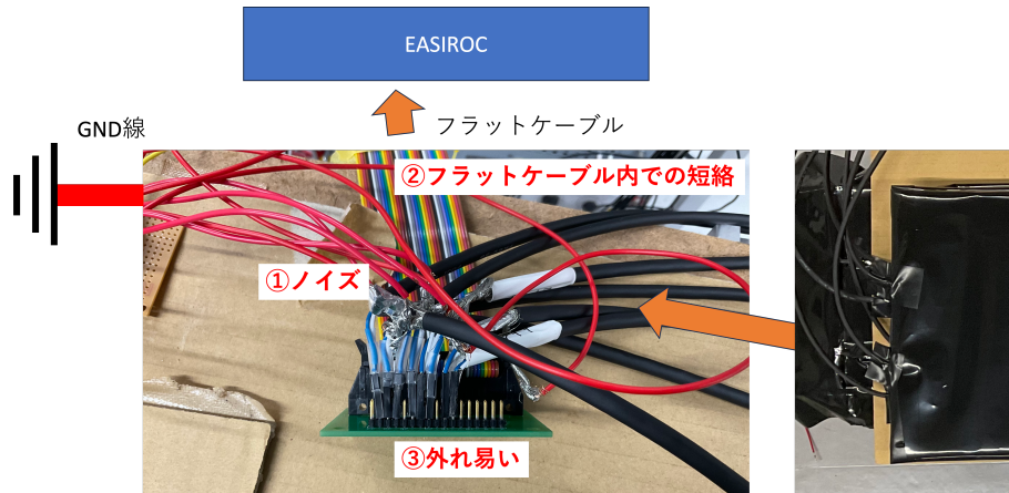
図 5.13: 事前動作測定により判明したトラッカーシンチレータの問題点
