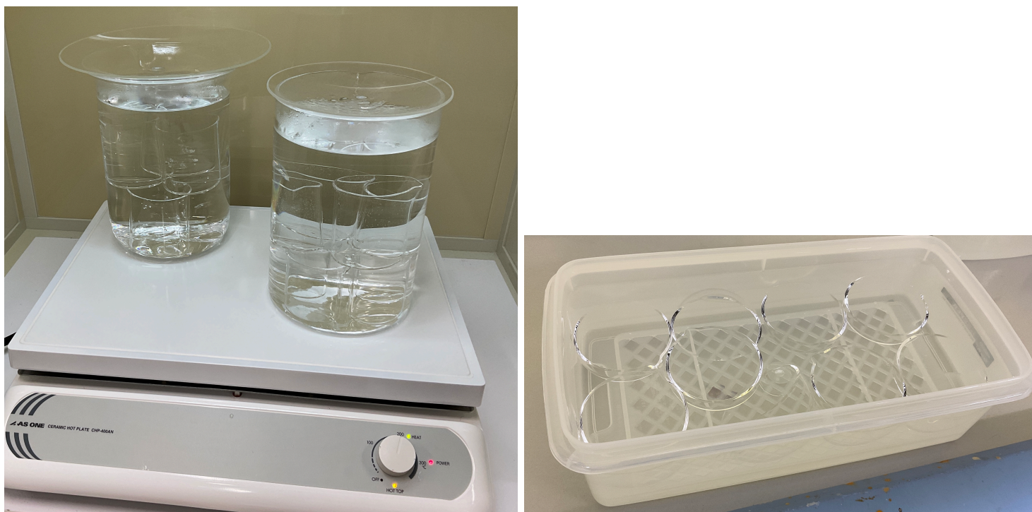
図 37: (左) ビーカーを硝酸に浸して熱しながら洗浄している様子 (右) 硝酸で洗浄したビーカーを TMSC に浸け置いている様子 (実際は蓋をしている)
