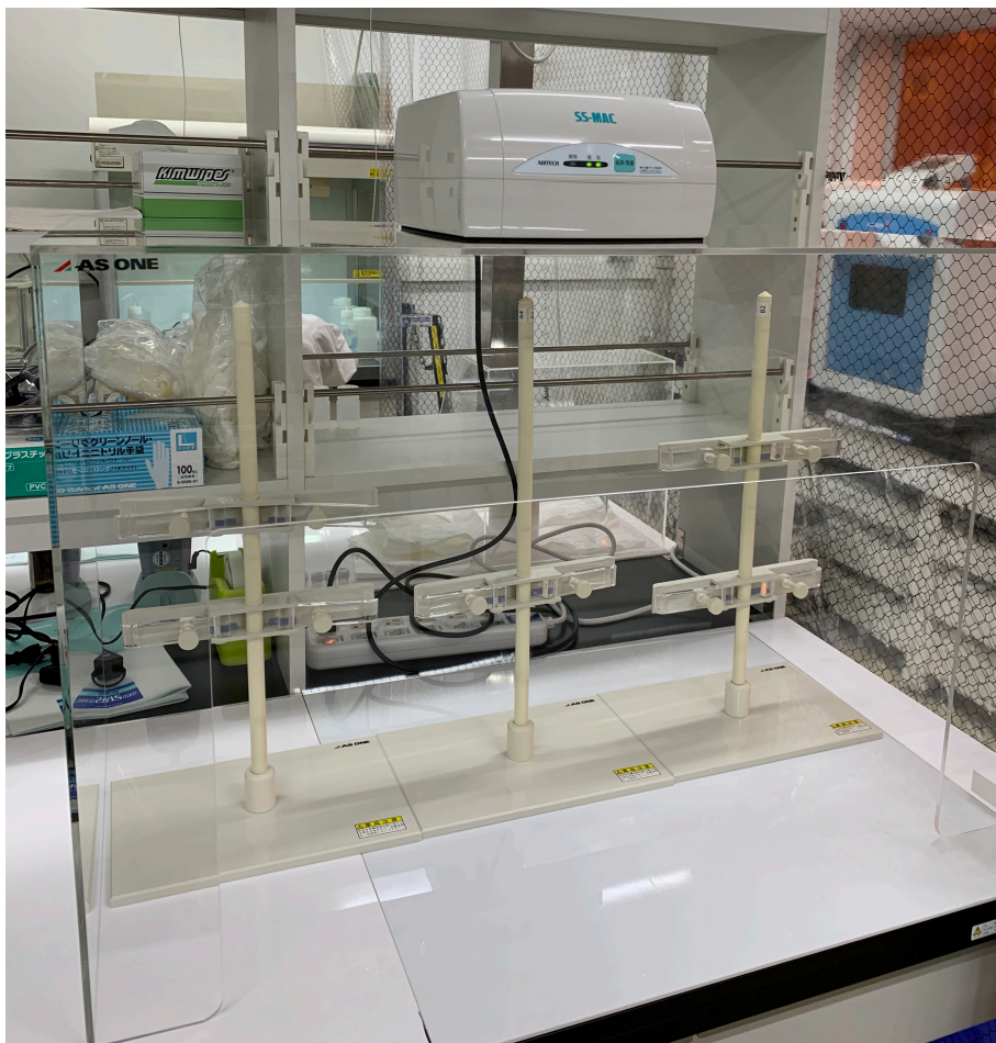
図 35: 筑波大学クリーンルームに設置したクリーンフード
