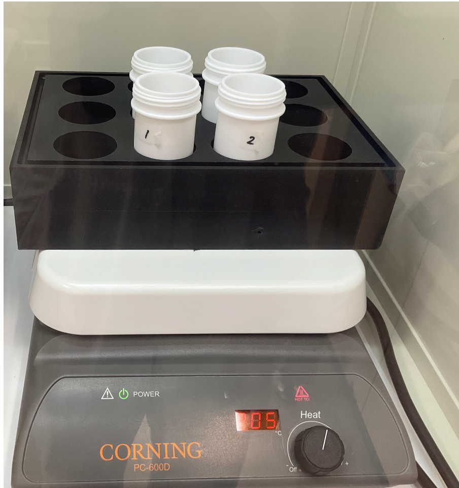
図 55: テフロン溶液に移し替えた試料を加熱している様子
