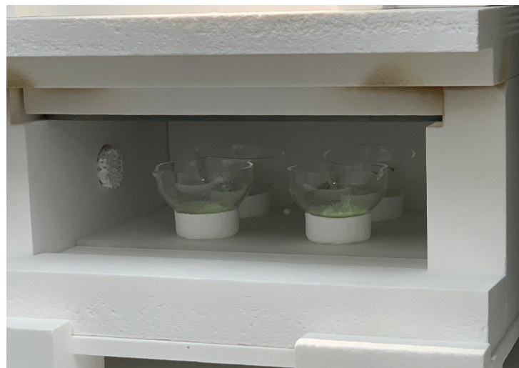
図 61: Bis-MSB を灰化炉に設置した様子
