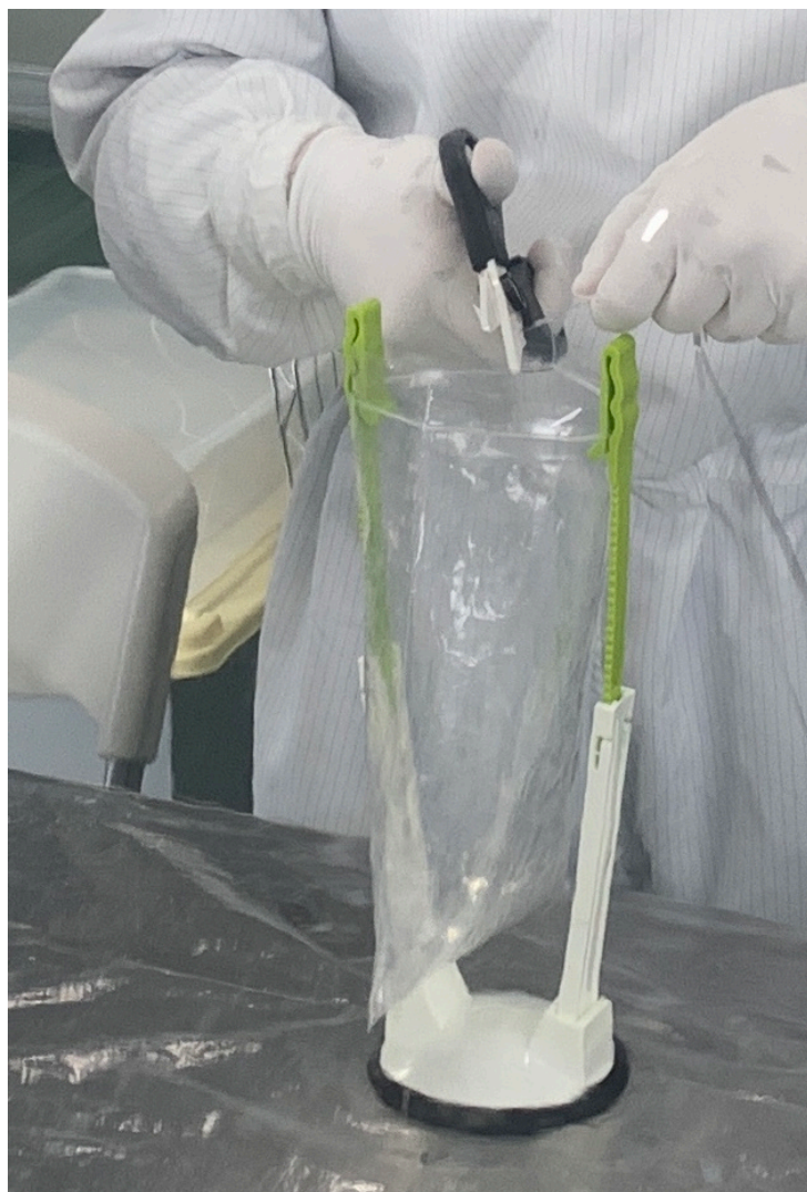
図 46: 洗浄後の PEN フィルムを切っている様子
