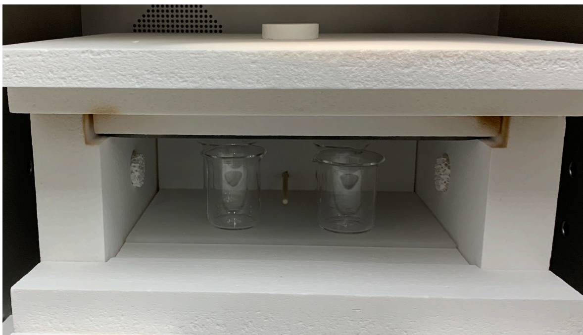
図 47: ビーカーが灰化装置に設置された様子。PEN フィルムの灰化後の写真のため、ビーカーの中は PEN フィルムの灰分。
