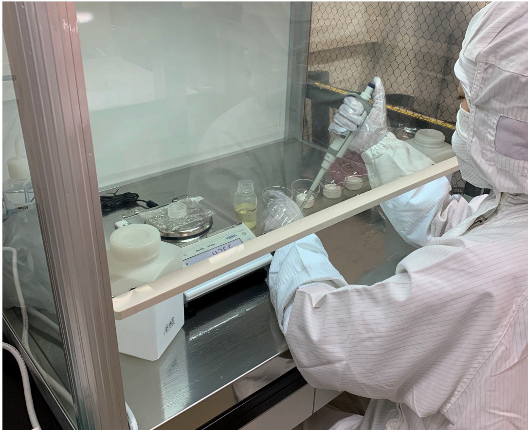
図 48: 灰化後の残留物を硝酸で溶液化している様子
