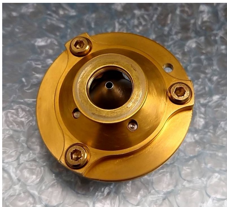
図 25: 本研究で用いた、高感度と低検出限界が得られる特殊な設計の s-レンズ
