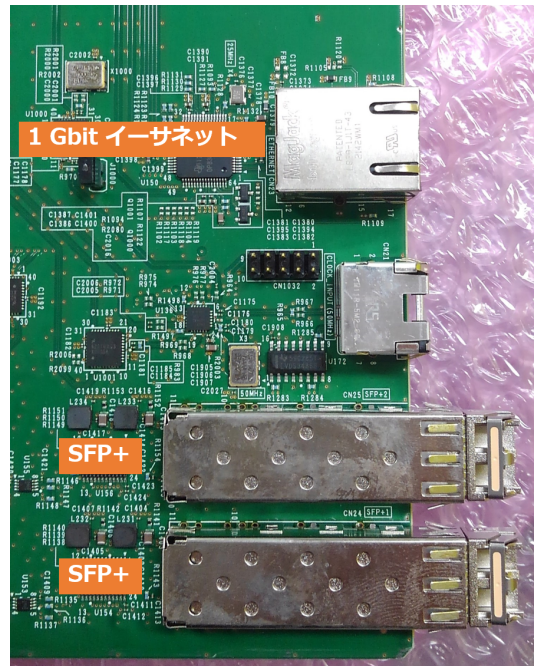
図 5.4 プロトタイプボードのデータ通信のインターフェース
