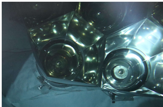
図 6.8 タンク上部から見た CH1 の PMT。左が CH0、右が CH1。光電面が剥がれ、透明になっていることがわかる。
