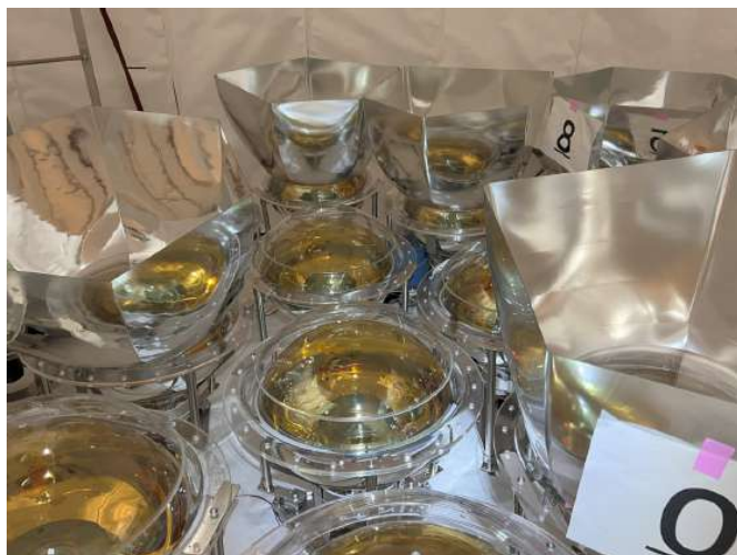
図 4.14 ミラーインストール中の様子。アクリルドームには丸い溝が掘ってあり、その溝に合わせてミラー下部を合わせて設置した。
