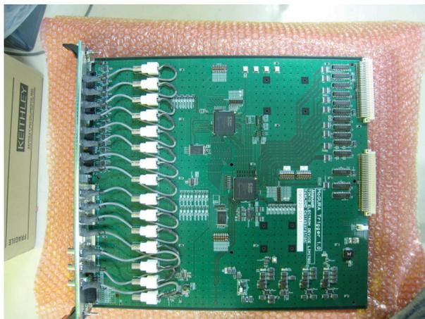
図 4.12 MoGURA Trigger ボード<sup>21</sup>
