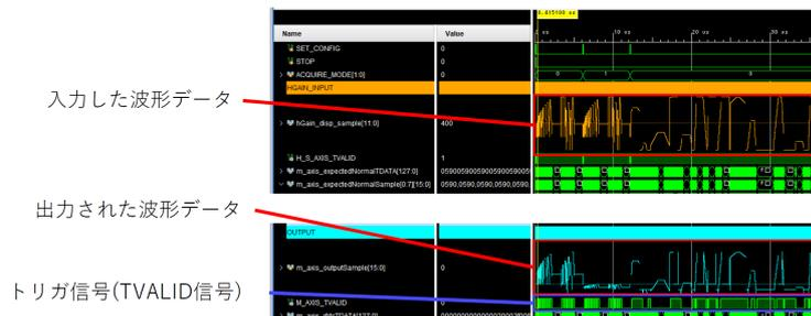
図 6.9 トリガーブロックのシミュレーション結果。実際のシミュレーションでは入力データから想定される出力データと、トリガ信号でマスクした出力データを自動で比較している。
