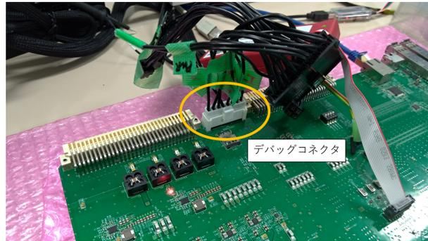
図 5.6 プロトタイプボード上に取り付けられたデバッグコネクタ
