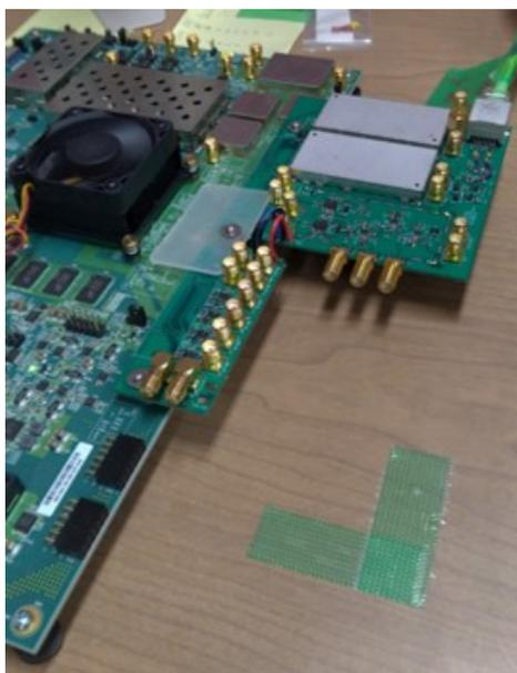
図 6.16 FEA ボード。図中左側の ZCU111 ボードに接続して使用する。
