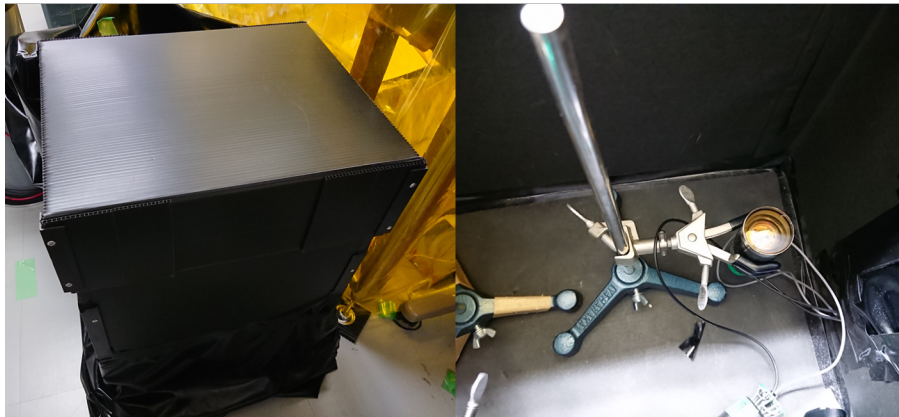
図 3.4 使用した実験装置。左図は暗箱でありこの内部で測定を行った。右図が暗箱内部の装置であり、中央の PMT に PEN, ^{241}\text{Am} を設置した。
