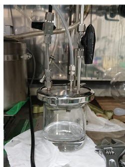
図 3.10 真空引きによる Xe の溶解
