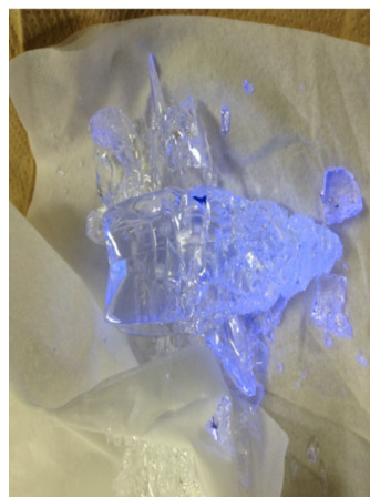
図 3.2 プラスチックシンチレータの発光と PC による腐食の様子。左図は紫外線により発光しているプラスチックシンチレータ。右図はそれを PC に 30 日間浸したものの、発光はしているものの、ゲル状に溶けており使用に耐えない。
