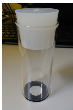
図 3.14 測定に使用したバイアル。通常のバイアルと比べて底面が平らな特注バイアルである。
