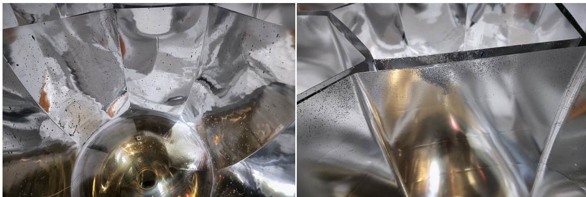
図 4.37 アルミニウムが剥離した集光ミラー (斑点状に見えるものが剥離した跡である。)
