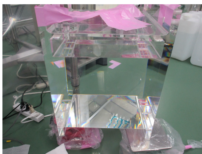
(d) 8 割程度の LAB-LS が注入されたアクリル容器
