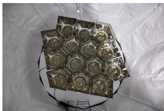
(d) 取付完了した PMT・集光ミラー
