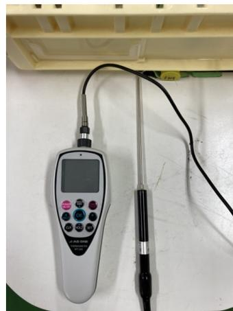
図 5.17 使用した温度計。測定誤差は  $\pm 0.1^{\circ}\text{C}$
