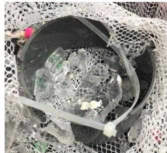
ボール A の破裂により、台座も破損してしまった
